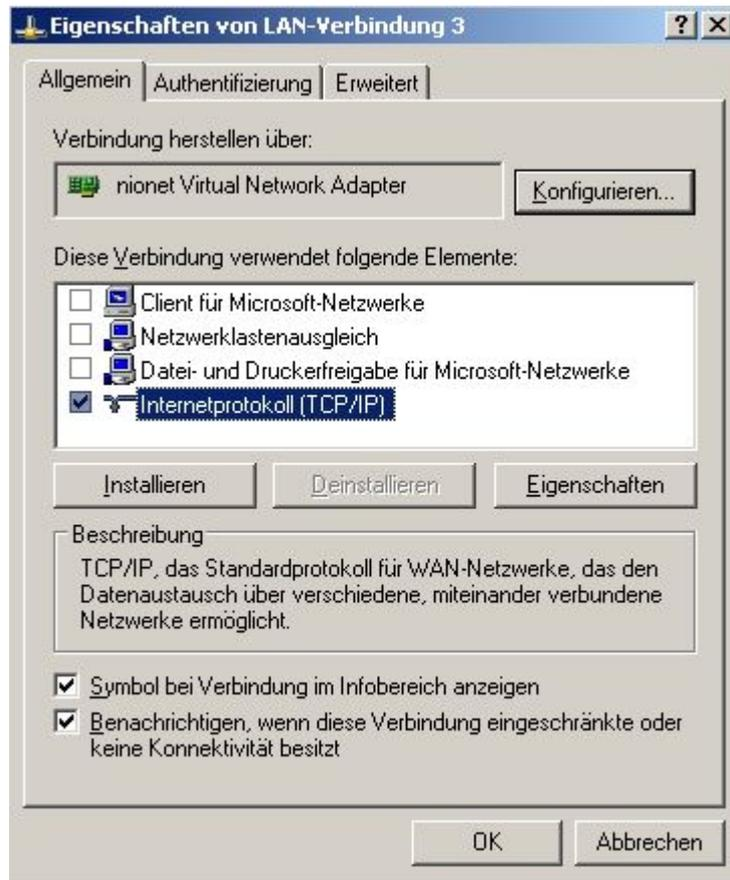
Unter 'Diese Verbindung verwendet folgende Elemente:' sollten zur Erhöhung der Sicherheit alle Häkchen bis auf der von 'Internetprotokoll (TCP/IP)' entfernt werden. Hier lohnt sich noch ein Blick auf die Eigenschaften.
